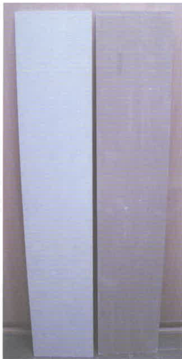
Рисунок 1 - Зовнішній вигляд зразка плити гіпсокартонної типу «А», що виробляється ТОВ „КНАУФ Гіпс Київ”, які були надані для випробувань.
