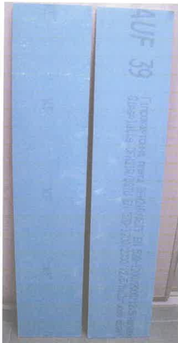
Рисунок 1 - Зовнішній вигляд зразка плити гіпсокартонної типу «DFH2IR», що виробляється ТОВ „КНАУФ Гіпс Київ”, які були надані для випробувань.
